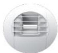
Les bouches CO2 assurent un débit d'extraction de 10 à 100m<sup>3</sup>/h sous 80 Pa en fonction du taux de CO2 présent dans le local où elles sont installées.
